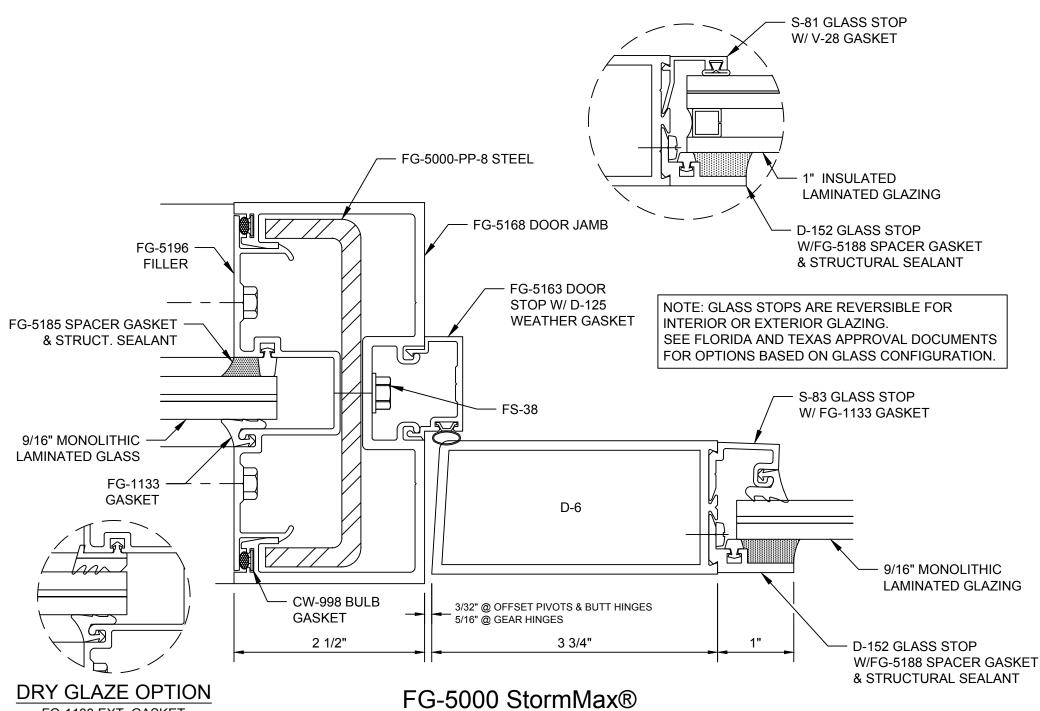
FG-1133 EXT. GASKET FG-5948 INT. GASKET FG-5000 StormMax®
